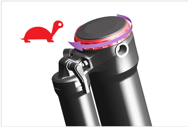
Seřízení: Zvýšení tlumení odskoku
