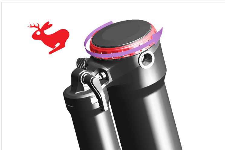
Seřízení: Snížení tlumení odskoku
